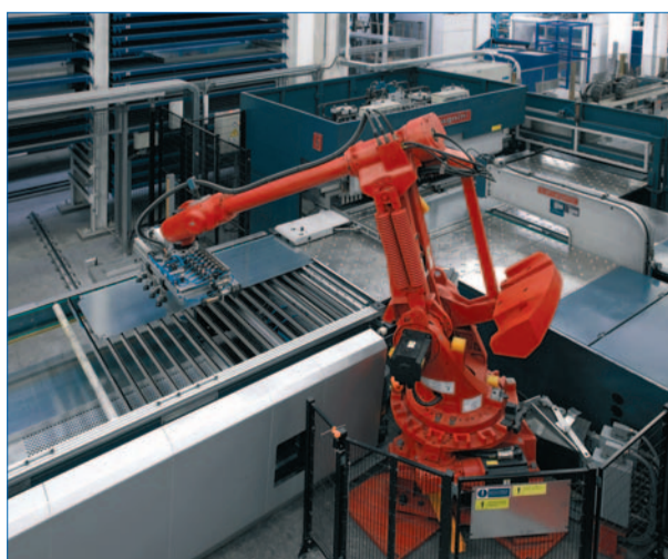
Dopo il taglio e la punzonatura, il robot trasferisce il pezzo lavorato alla pannellatrice
